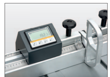
Cyfrowy wskaźnik pozycji przymiaru na ramie teleskopowym
